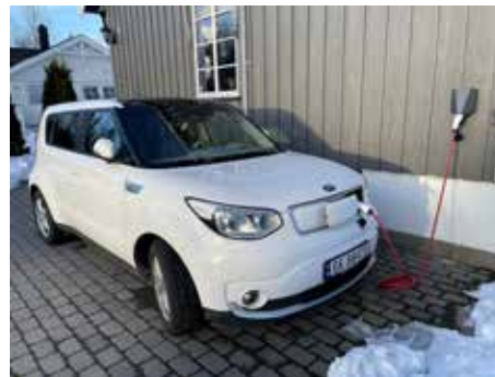
Sørger du for at bilen er ferdigladet rett før du skal kjøre, er batteriet allerede varmt. Det gir merkbart bedre rekkevidde, noe som er særlig viktig på biler med kort rekkevidde – som denne Kia Soul-en.
