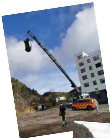
Bilen ble sluppet fra 30 meters høyde, noe som simulerer et sammenstøt i 60 km/t.
