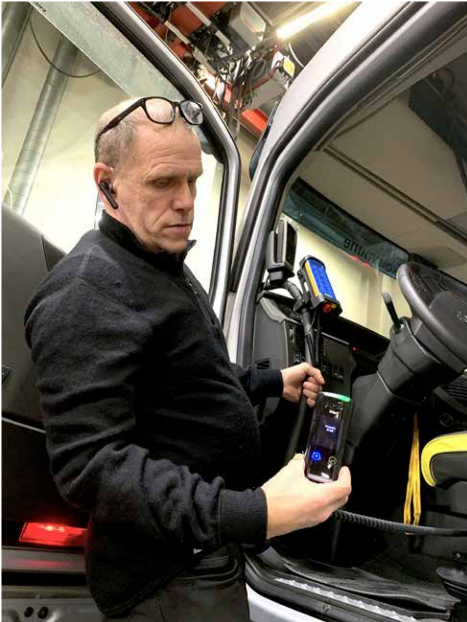
SIKKERHETSTILTAK: Maskinkjører Ole Ivar Alstad viser alkolåsen som er montert inne i lastebilen. Lastebilen starter ikke før det er blåst i munnstykket - og indikatoren lyser grønt. Foto: Levanger kommune
